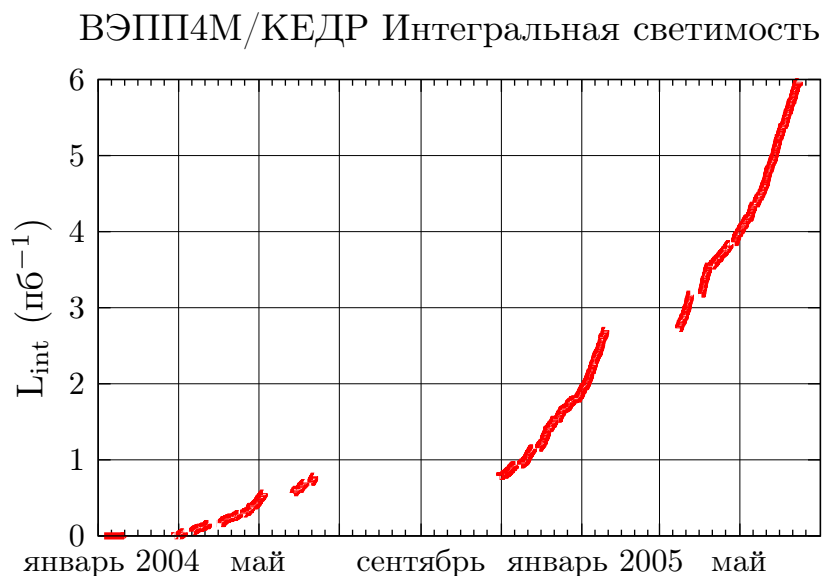
Рис. 4.9. Интегральная светимость от времени. Данные за полтора года (примерно 130 тысяч точек) обработаны с помощью программы gnuplot .
