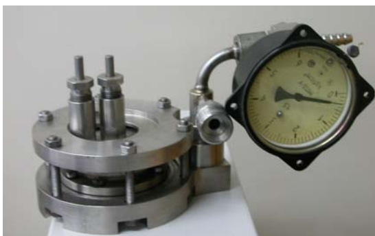
Рис. 9. Токоввод с изолятором (слева) и мишень с нагревателем и токовводом в сборе (справа).
