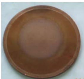
Рис. 13. Фотографии медного приемника после флуенса 10^{19} \text{ см}^{-2} без вспышки фотоаппарата (слева) и со вспышкой (справа).
