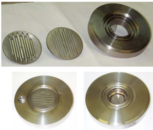
Рис. 2. Мишень перед сборкой (сверху) и после (слева — вид со стороны протонного пучка, справа — с противоположной стороны).
