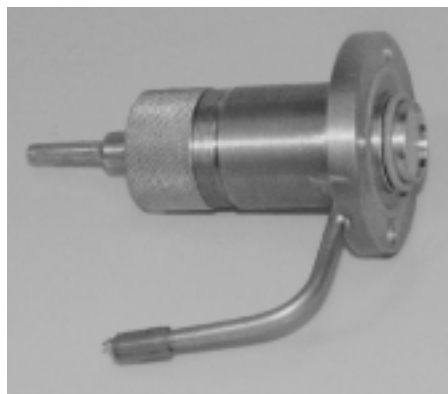
Рис. 1. Узел транспортировки образца. 1 – сопло, 2 – накидная гайка, 3 – корпус, 4 – поршень, 5 – место для размещения образца.
