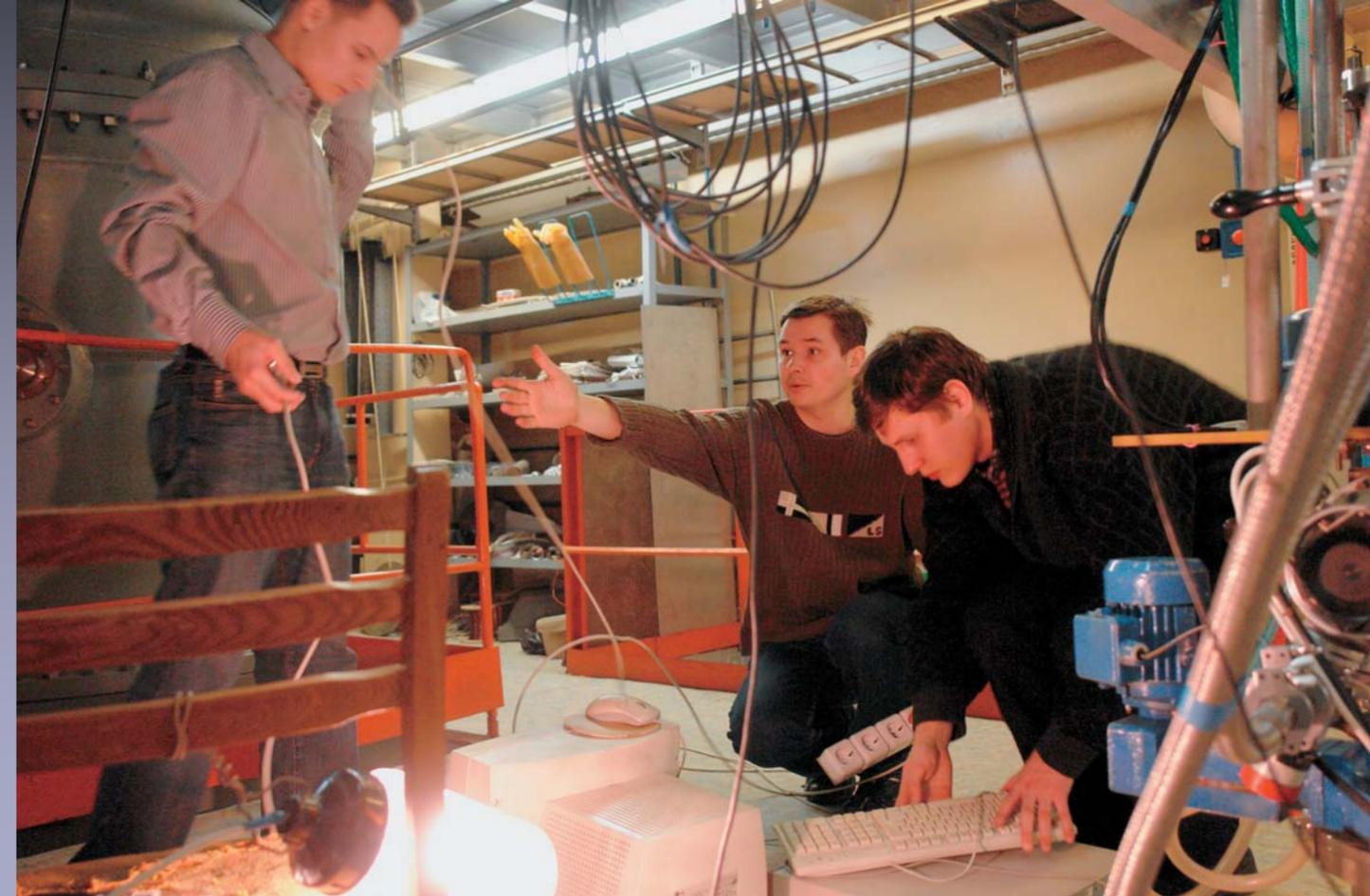
На сегодня исследователям удалось решить все физические проблемы, мешавшие создать компактный ускорительный источник для нейтронозахватной терапии рака. Таким образом, менее чем за десять лет специалисты ИЯФ СО РАН разработали и создали действующий образец установки – компактный и относительно недорогой источник нейтронов, предназначенный специально для размещения в онкологических центрах.
