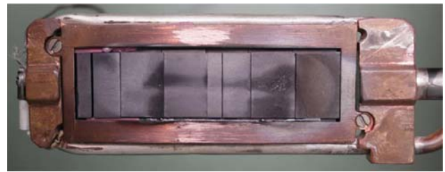
Рис. 4. Подвижная мишень после испытаний мощным протонным пучком.
