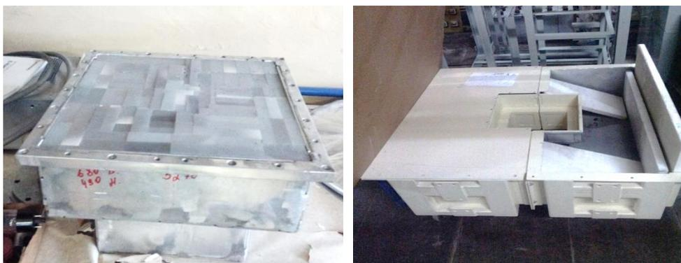
FIGURE VI. 28 — Les parties fabriquées du BSA modélisé (le modérateur à gauche, une partie du container du réflecteur à droite)
