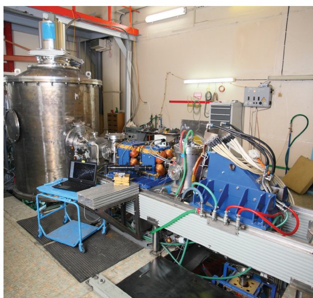
Рис. 4. Ускоритель-тандем с вакуумной изоляцией: общий вид (слева), схема (справа): 1 – H^- -источник, 2 – магнитные линзы, 3 – ускоритель, 4 – криогенный насос, 5 – промежуточные электроды, 6 – высоковольтный электрод, 7 – газовая обдирочная мишень, 8 – проходной изолятор, 9 – высоковольтный источник питания, 10 – турбомолекулярные насосы. Стрелки показывают направление распространения отрицательных ионов водорода ( H^- ) и протонов (p)
