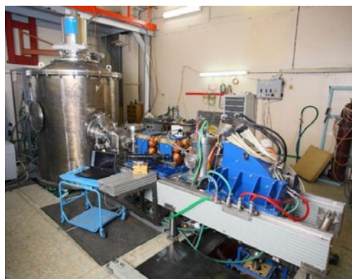
Рис. П.4.1. Ускоритель-тандем с вакуумной изоляцией: схема (слева), фотография (справа): 1 — источник \text{H}^+ , 2 — магнитные линзы, 3 — ускоритель, 4 — криогенный насос, 5 — промежуточные электроды, 6 — высоковольтный электрод, 7 — газовая обдирочная мишень, 8 — проходной изолятор, 9 — высоковольтный источник питания, 10 — турбомолекулярные насосы
