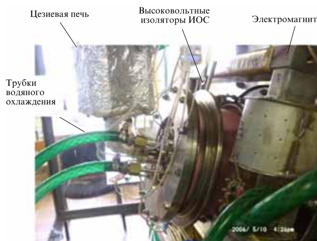
Рис. 4. (В цвете онлайн.) Первый стационарный пеннинговский ионный источник, разработанный для ускорителя-тандема.
