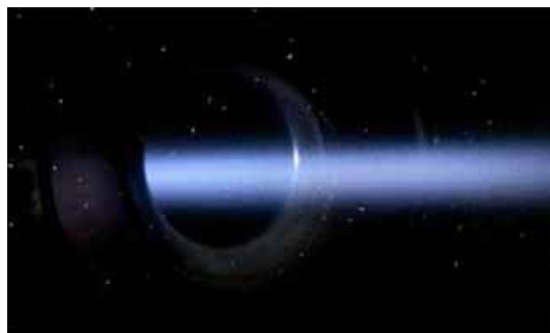
Рис. 8. (В цвете онлайн.) Изображение пучка, снятое видеокамерой при протонном токе 9 мА.
