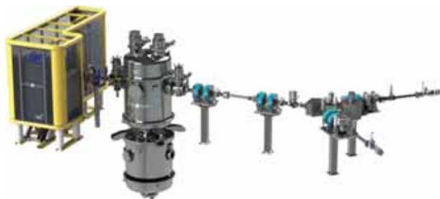
Рис. 21. (В цвете онлайн.) Вид нейтронного генератора с трактом пучка низкой энергии, ускорителем-тандемом, трактом пучка высокой энергии и системой разводки пучка по каналам на нейтроногенерирующие мишени в помещениях для облучения пациентов.
