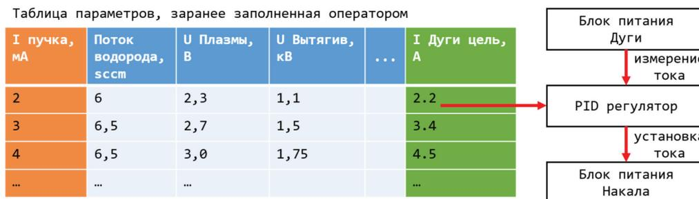
Рис. 3. Таблица параметров и логика PID-регулятора
