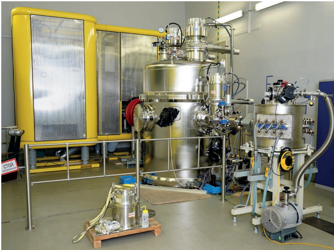
Рис. 3. Ускорительный источник нейтронов VITA-II \alpha перед отправкой в Китай Fig. 3. Accelerator based neutron source VITA-II \alpha before shipment to China
