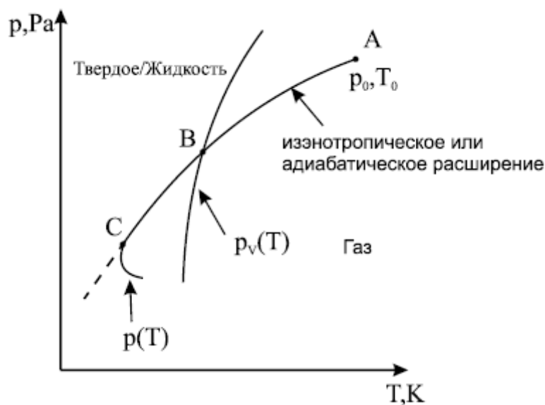
Рисунок 1. Фазовая диаграмма. p_v(T) — двухфазная линия жидкости и газа, p(T) — линия расширения газа [7]
