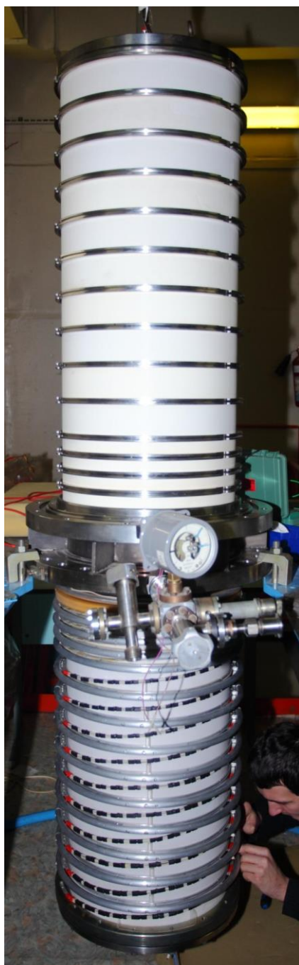
Рис. 19. Новый проходной изолятор
