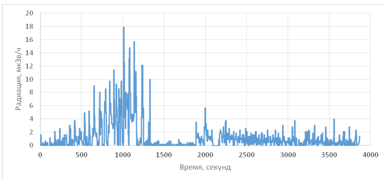
Рис. 15. Сопутствующее рентгеновское излучение при подъеме напряжения и выдержке гладкого керамического изолятора.
