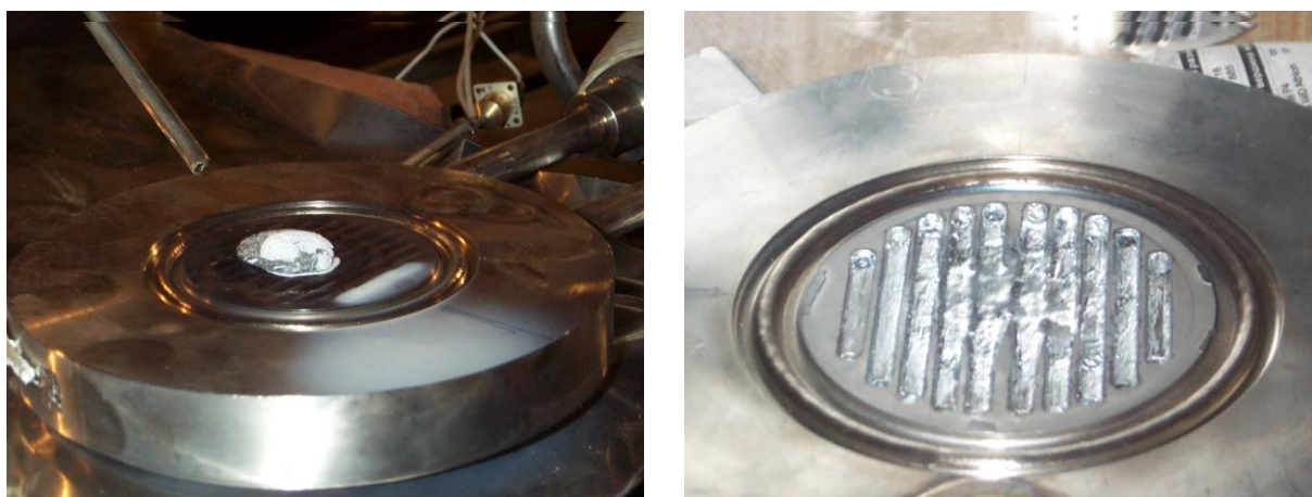
Рис. 3. Фотографии мишени с вытекшим на поверхность галлием через образовавшееся отверстие (слева) и стального диска с каналами для охлаждения после удаления молибденовой фольги.
