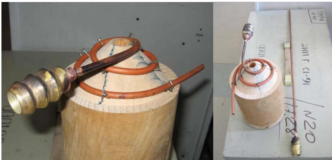
Рис. 17. Модель винтообразного канала охлаждения (слева) и она же в сравнении с прямой трубкой такой же длины
