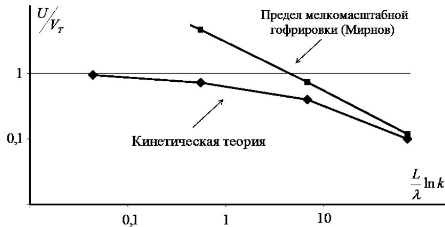
Рис. 9: Зависимость средней направленной скорости течения, деленной на тепловую, от отношения длины ловушки к эффективной длине свободного пробега (L/\lambda)I при истечении в вакуум. ( T = 1000\text{эВ} , k = 10 )
