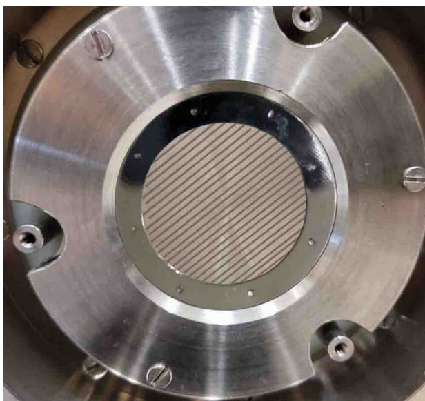
Рисунок 8. Щелевая пластина, смонтированная на анализатор.
