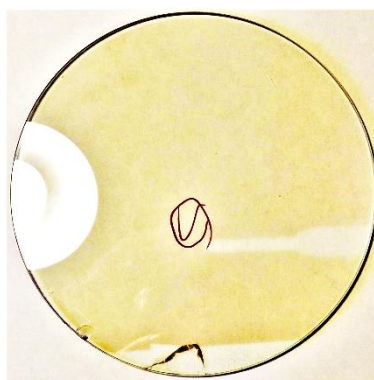
Рис. 35. Фотография стекла после ~100 выстрелов в него из плазменной пушки. Контрастность усилена программным образом.
