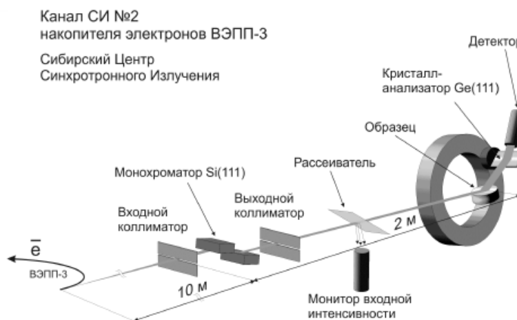
Рисунок 3. Общая схема экспериментальной станции на канале №2 вывода СИ накопителя электронов ВЭПП-3
