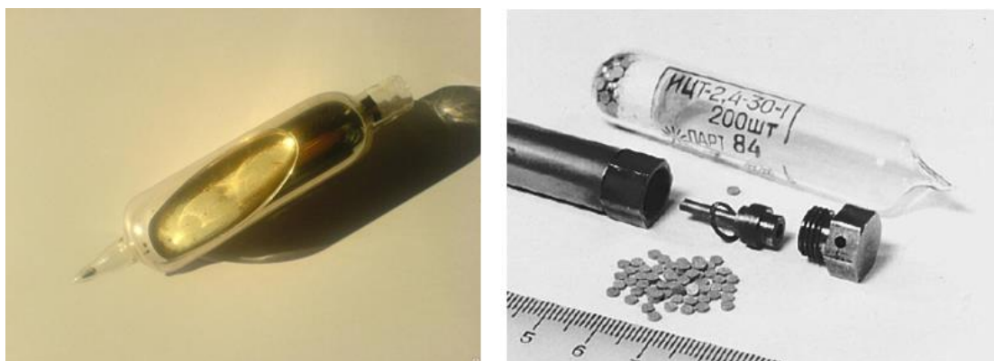
Рисунок 4. Металлический цезий и прореагировавший цезий в таблетках.
