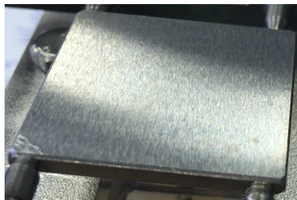
(б) Пластина со шлифованной облучаемой поверхностью (толщина 2 мм)
