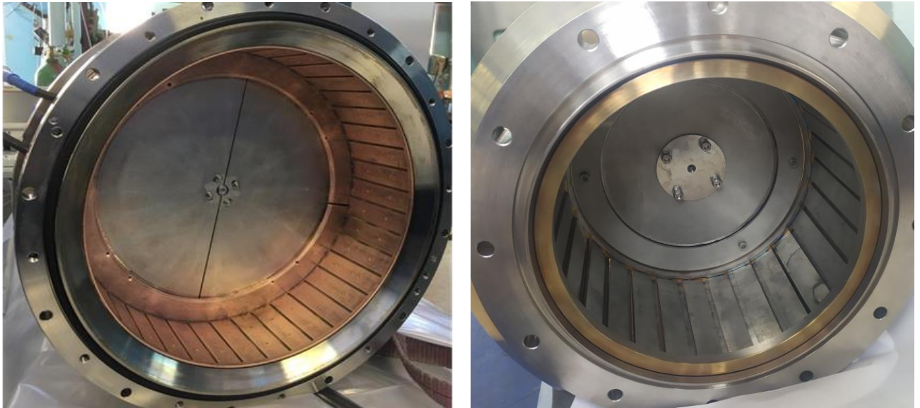
Рис. 6 Фарадеевские экраны, установленные в эмиттеры.
