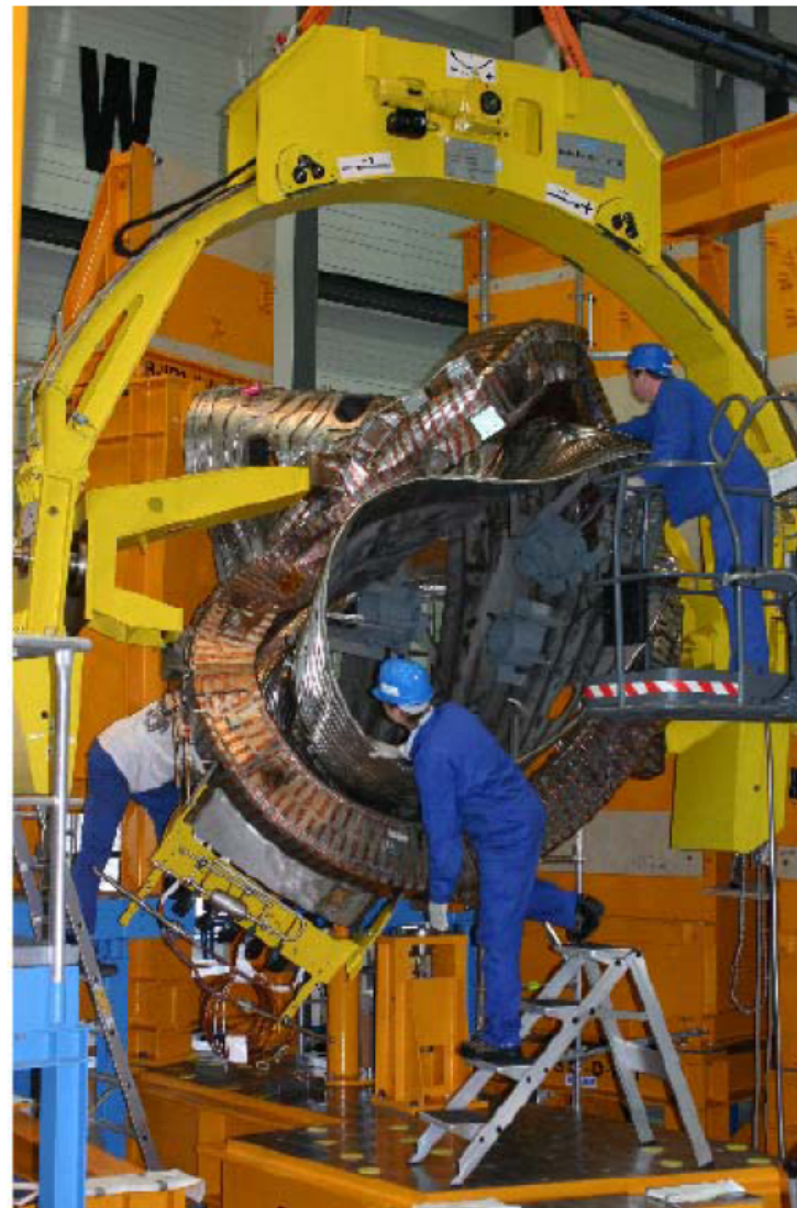
отработка технологии монтажа катушек
