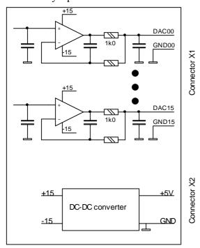
Из приведенной схемы следует, что все выходы цифроаналогового преобразователя буферированы специальной схемой, которая обеспечивает следующее:
