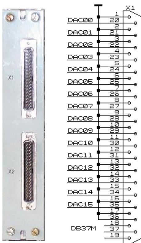
На разъем X1 выведены аналоговые напряжения многоканального ЦАПа. Выходы аналоговых напряжений не являются гальванически изолированными, а имеют общую землю. Соединение с нагрузкой рекомендуется осуществлять витыми парами. Входное сопротивление нагрузки не рекомендуется менее 10 Ком.
