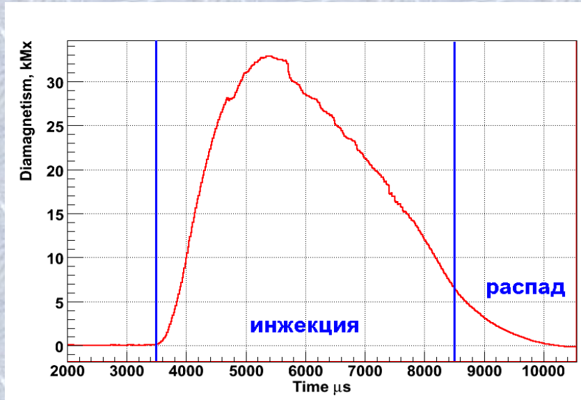
Диамagnetный сигнал быстрых частиц без инъекции газа
