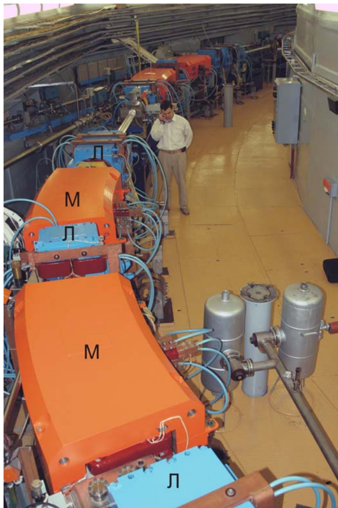
Рис.2.1.1 Ячейка периодичности накопителя электронов – источника синхротронного излучения «Сибирь-2», разработанного в ИЯФ СО РАН. Обозначены поворотные магниты (М) и квадрупольные линзы (Л).
