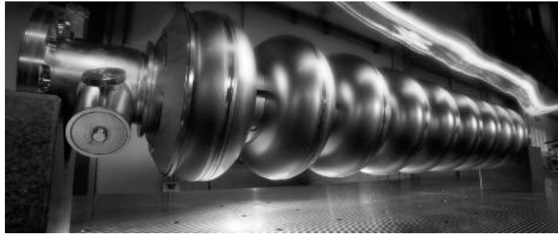
Рис. 1.9.1. Сверхпроводящая структура для International Linear Collider
